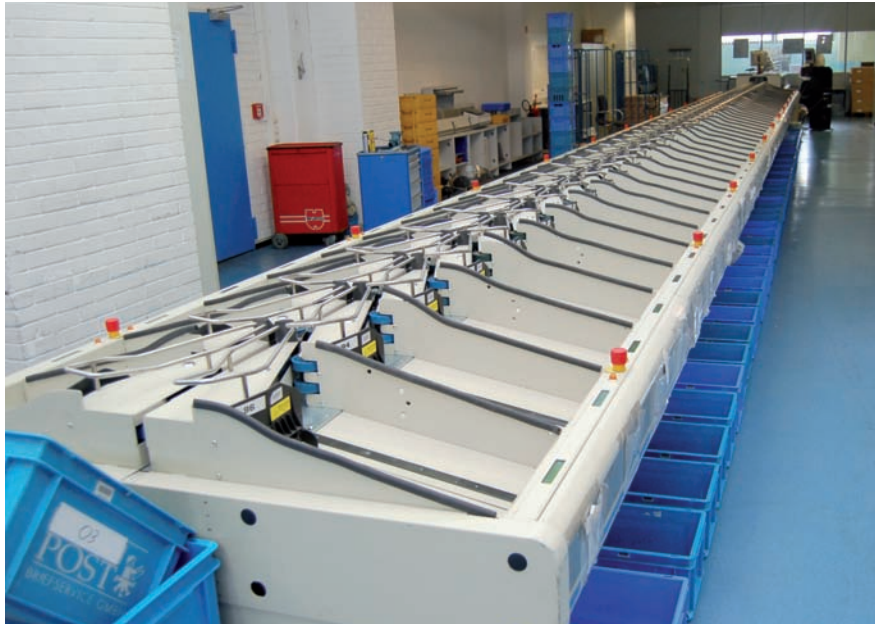
Von der Orts- zur Feinsortierung mit der großen Sortiermaschine
