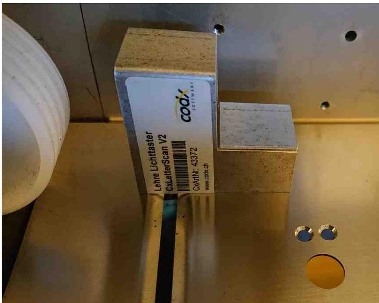
Abbildung 23 Einstellung Lichttaster Mitte und hinten
