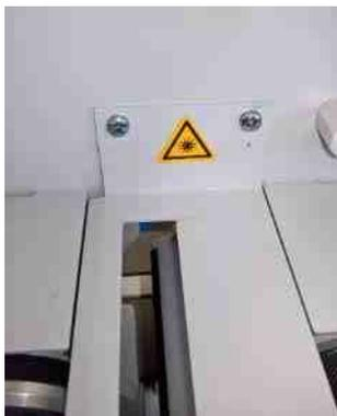
Abbildung 9 Sicherheitskleber Beleuchtung
