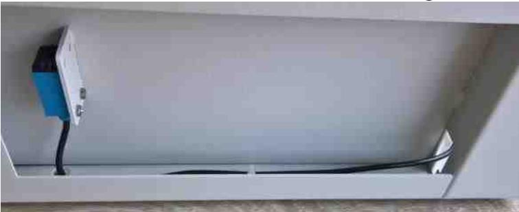
Abbildung 27 Lichttaster Endmodul
